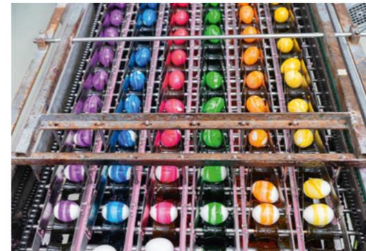
Bei diesem Färbeprozess werden die Eier über mit Eierschalenlack benetzte Rollen gerollt, auf denen sie marmoriert werden. Die Rollen drehen das Ei so, dass es vollständig mit Eierschalenlack bedeckt wird. Durch das mehrmalige Drehen werden einige Stellen des Eis mehrfach lackiert, wodurch die typische Marmorier-Optik entsteht. Braune Eier werden auf diese Weise und mit den dunkleren Farben wie Rot, Blau und Violett gefärbt.
