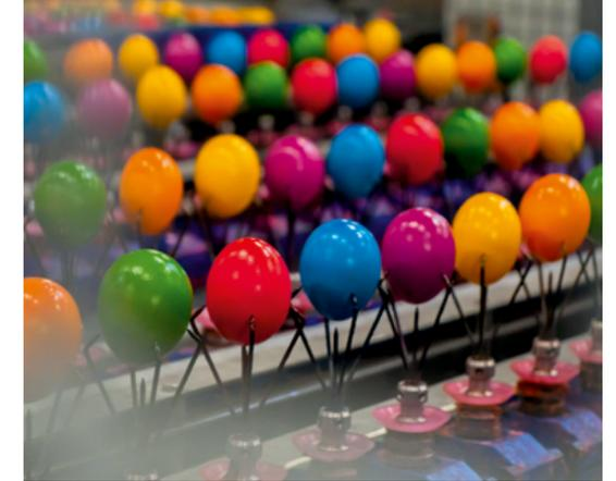
Sprühverfahren lassen sich entweder eine intensive einfarbige Färbung oder alternativ eine Regenbogen- oder Ringeloptik umsetzen. Alle lackierten Eier trocknen anschließend ihr neues Antlitz in einem Kühlkanal.
